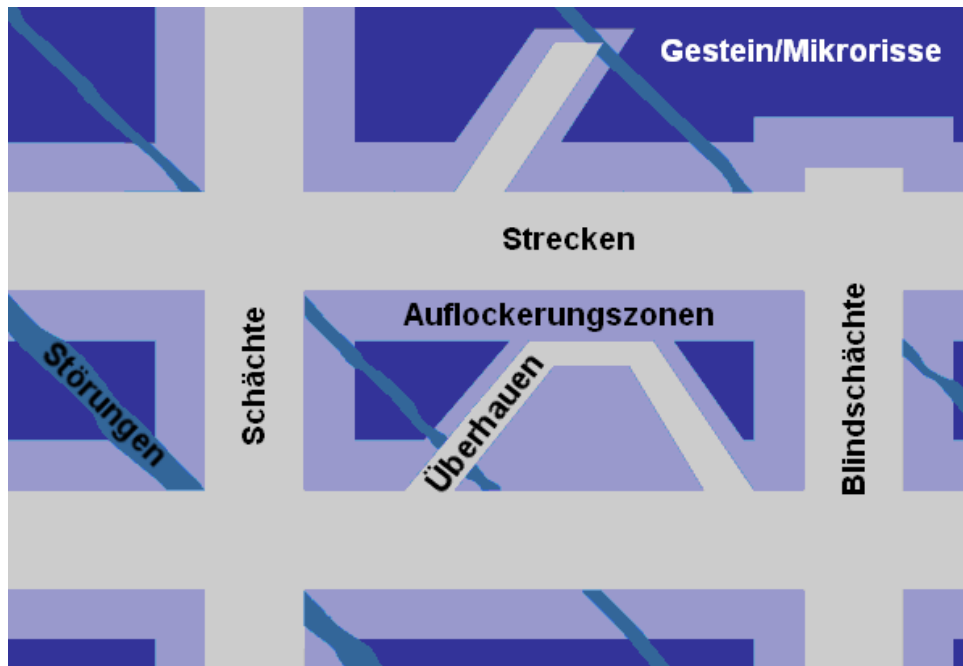
Abbildung 4: Prinzipdarstellung der Wasserwegsamkeiten in einem Bergwerk (Saigerriß; WOLKERSDORFER 1996)
